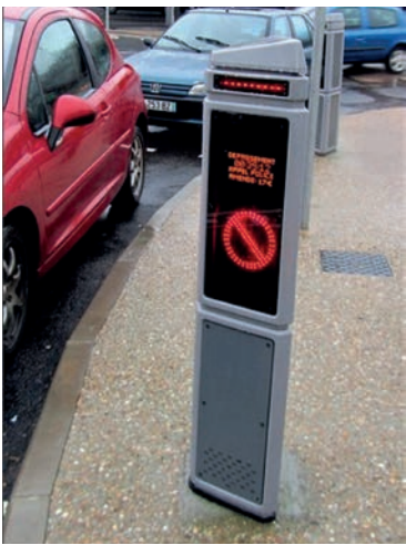
Des dispositifs dynamiques peuvent être utilisés en complément de la signalisation pour informer l'usager du dépassement de la durée. C'est le cas de ces bornes sur chaque emplacement associées à des capteurs au sol.
