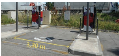
Exemple d'emplacement réservé à la recharge de véhicules électriques accessible aux personnes titulaires de la carte mobilité inclusion, mention « stationnement » tant pour la place que pour la borne elle-même. La peinture de l'emplacement n'est pas souhaitée.
