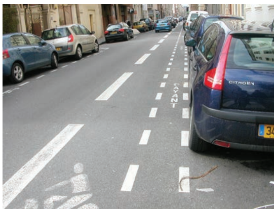
Une bande de 0,50 m est aménagée entre la bande cyclable et le stationnement pour éviter les accidents liés aux ouvertures de portières des voitures.
