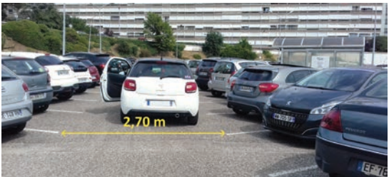
Ce parc organisé en épis à 60° présente des dimensions très réduites (e = 2,50, b = 2,70, c = 10,80 m) optimisant le nombre de places au mètre carré sans créer de dysfonctionnements.
