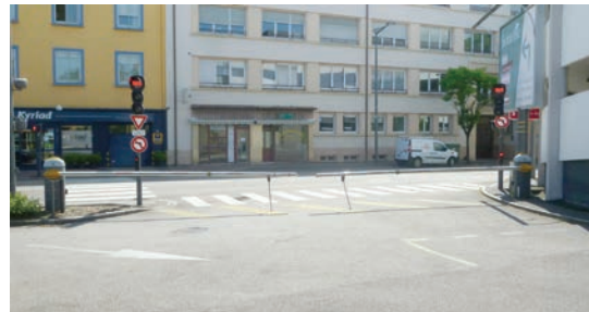
Barrière, feux, passage piétons permettent la sortie des cars et des bus en toute sécurité. Un accès large assure la giration des véhicules qui s'insère dans la rue.
