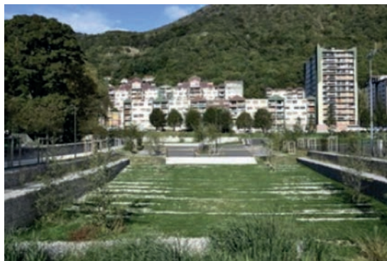
Exemple d'un parking dont une partie est perméable et sert de bassin de stockage des eaux pluviales.
